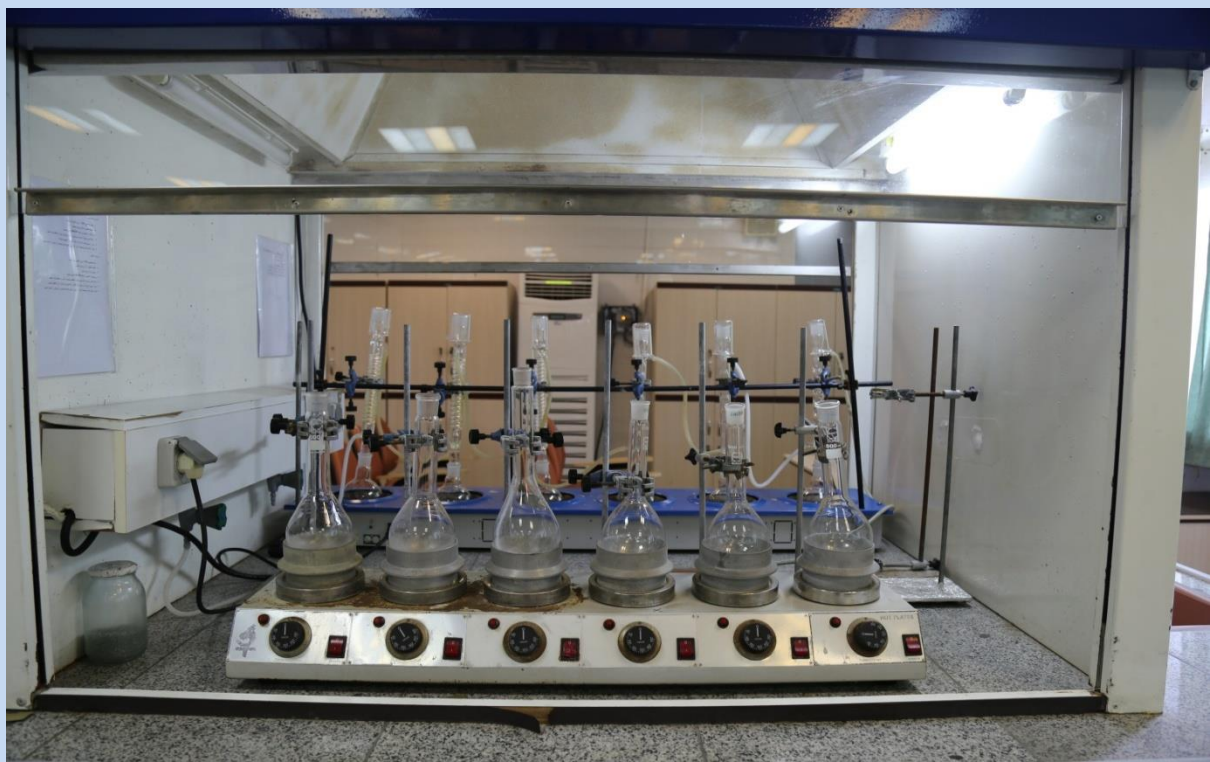
راکتور گرمایی (آزمایش TKN)
