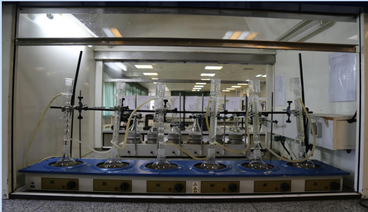
راکتور گرمایی (آزمایش COD)
